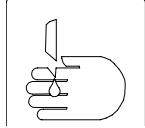
Dieses Piktogramm warnt vor der Gefahr von Schnittverletzungen der Hände. Halten Sie Ihre Hände von der Stachelrolle fern, wenn diese in Betrieb ist. Die Stachelrolle enthält scharfe Messer, die Schutzhülle der Stachelrolle darf nicht entfernt werden.
