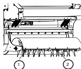
Um die Messer auszutauschen, müssen Sie zuerst die Messerachse von der Maschine lösen. Dazu gehen Sie wie folgt vor:
