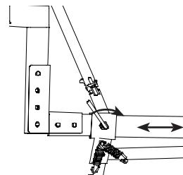
Die Höhe der Bedienung des Transportbandes kann mit Hilfe des Sternknopfes angepasst werden. Nachdem dieser gelöst wurde, wird die Stange wieder in der gewünschten Höhe befestigt.
