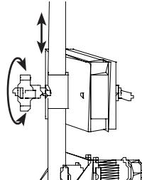
Die Bedienung des Transportbandes kann an der Höhe angepasst und verschoben werden, so dass sich dieses in einer einfach zugänglichen Position befindet.
