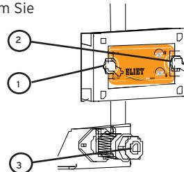
Um die Kontaktdose von dem festen Fuß am Traktor zu lösen, löst man den Sternknopf hinten an der Dose, anschließend schiebt man die Dose über die Stange nach oben. Lösen Sie den Stecker vom Ständer.
